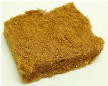
Bild 6: Holzfaser Platten nicht gepresst
